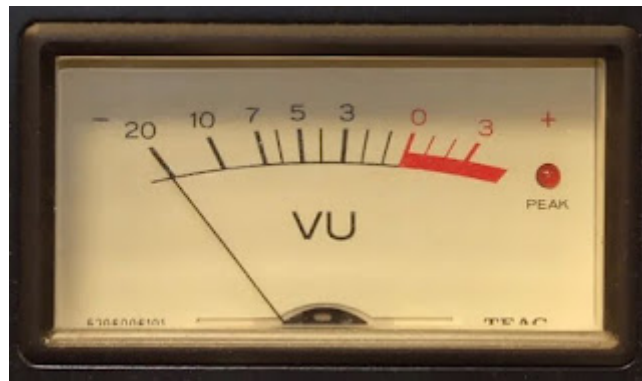
De schaalindeling in VU's van een standaard analoge VU-meter. (© Iain Fergusson)
